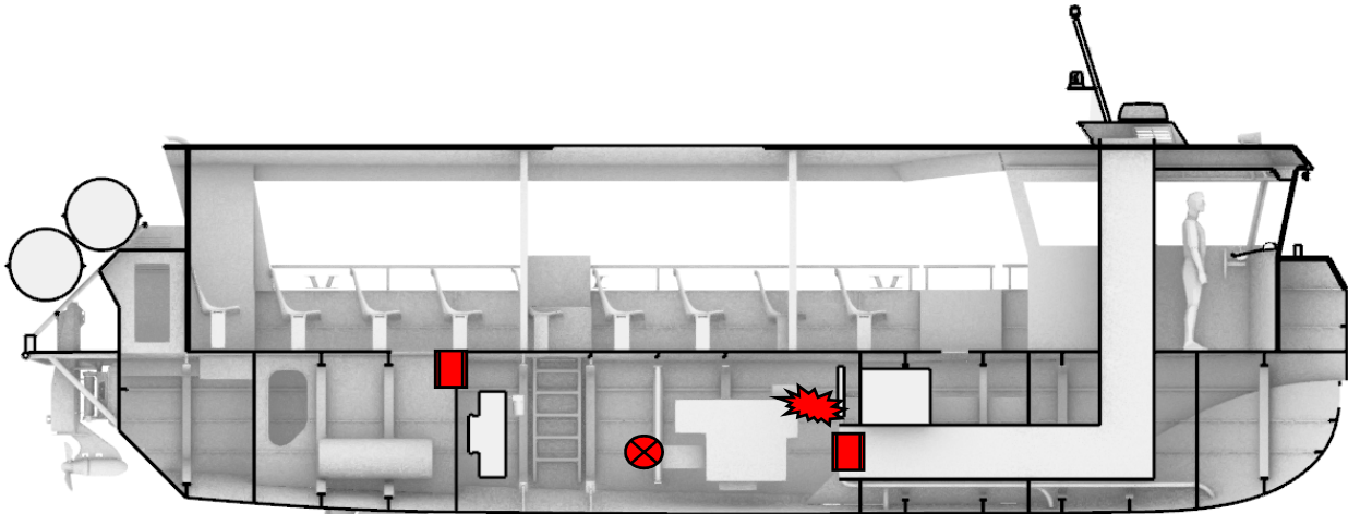
Figure 12 Principe du système de lutte contre l'incendie
