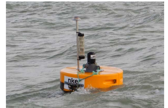
Figure 3 : Sonde multi paramètres à demeure (IDRA)
