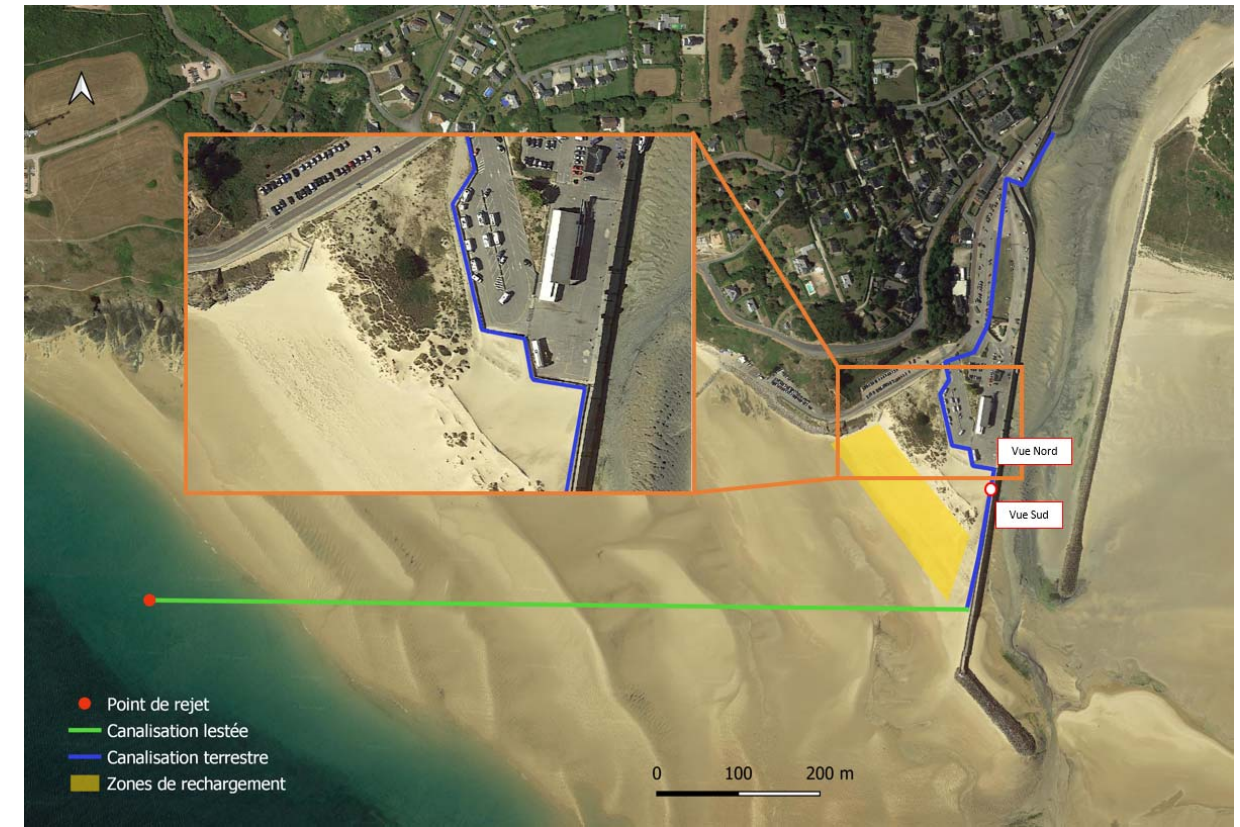
Figure 76 : Passage de la canalisation de refoulement (IDRA, 2022)
