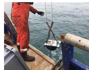
Figure 8. Utilisation de la Benne Van Veen d'IDRA Bio & Littoral : surface d'échantillonnage de 0,1 m 2
