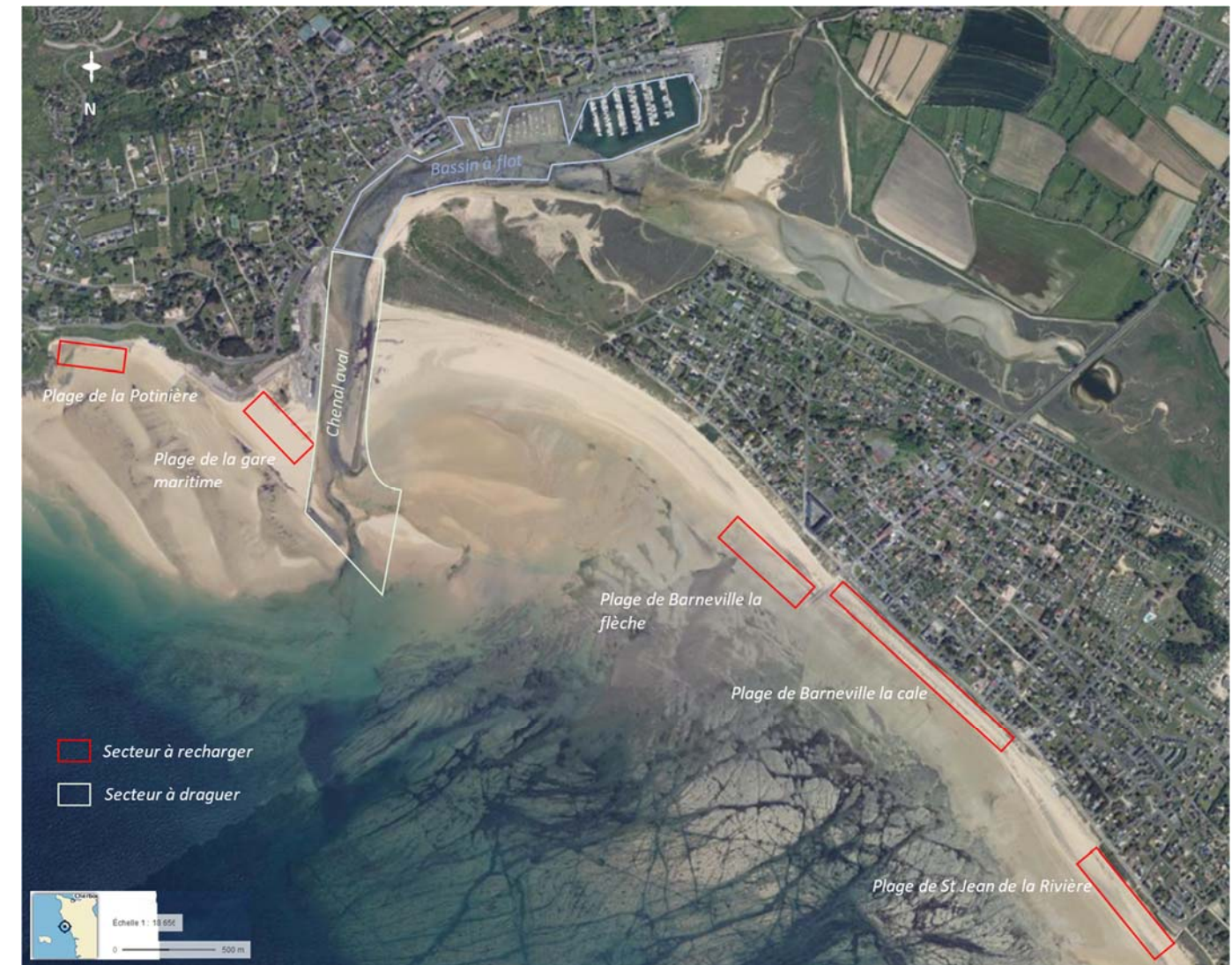
Figure 18 : Localisation du port de Barneville-Carteret, des zones de dragage et des zones de rechargement
