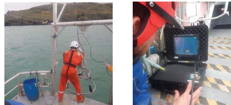
Figure 6 : Mise à l'eau de la vidéo tractée et visualisation des fonds depuis la surface.
