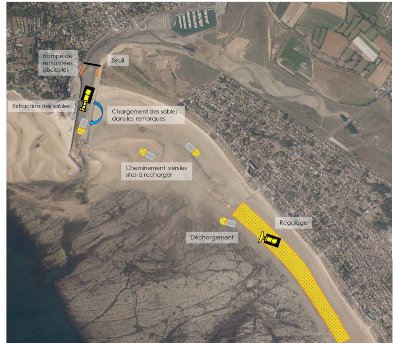
Figure 10 : Organisation de chantier lors de l'extraction des sédiments
