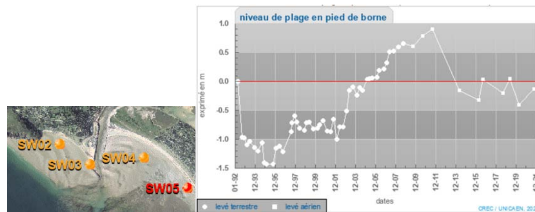
Figure 27 : Niveau altimétrique du point SW05 (CREC)
