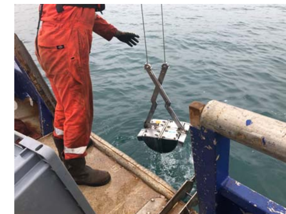
Figure 84 : Utilisation de la Benne Van Veen d'IDRA Bio & Littoral : surface d'échantillonnage de 0,1m 2
