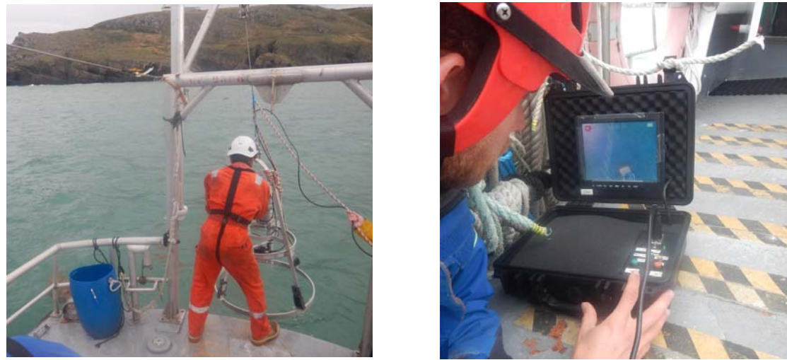
Figure 82 : Mise à l'eau de la vidéo tractée et visualisation des fonds depuis la surface (IBL, 2021)
