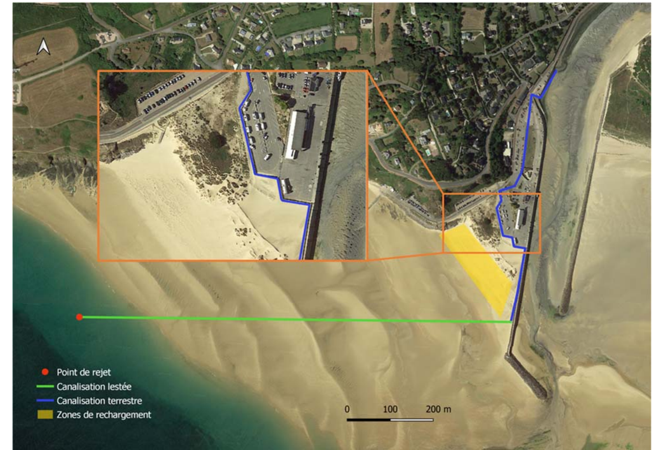
Figure 13 : Passage de la canalisation de refoulement (IDRA, 2020)
