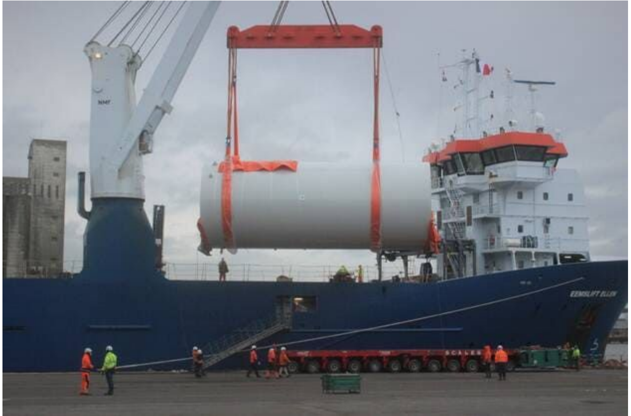
Le premier mât d'éolienne a été débarqué la semaine dernière sur le quai de la Prise d'Eau | PO-ND
